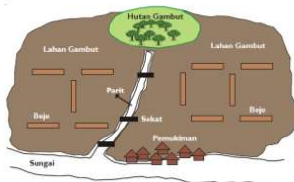
Gambar 2. Skema penempatan kolam beje dan sekat parit sebagai media budidaya ikan dan sekat bakar di kawasan budidaya lahan gambut (Najati et al., 2005)
